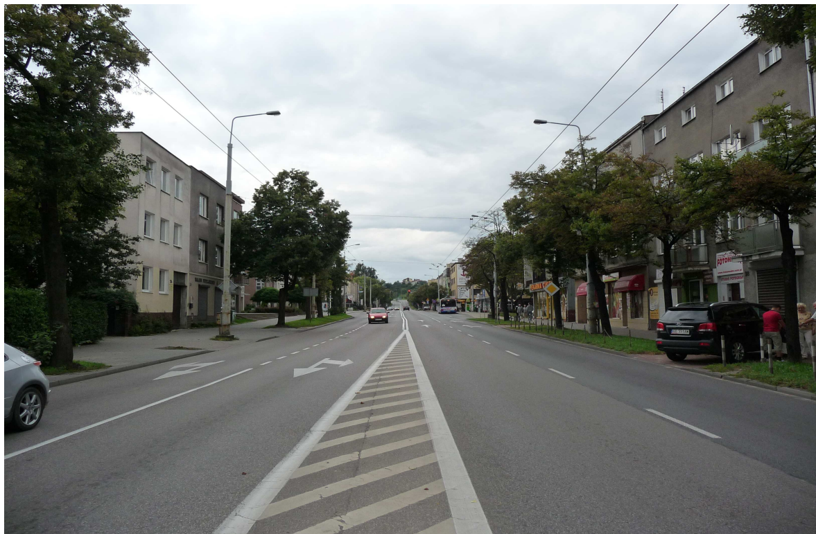
Ul. Wielkopolska stanowiąca fragment drogi wojewódzkiej nr 474 (ul. Chwaszczyńska, ul. Wielkopolska) łącząca Gdynię z drogą krajową nr 22 to dwupasmowa droga w obu kierunkach, oprócz istniejącej zabudowy blisko drogi; wielu wjazdów i zjazdów; posiada istniejącą trolejbusową sieć trakcyjną, co powoduje, że zastosowanie ekranów akustycznych jest wykluczone (foto: SecTec Adam Naguszewski).
