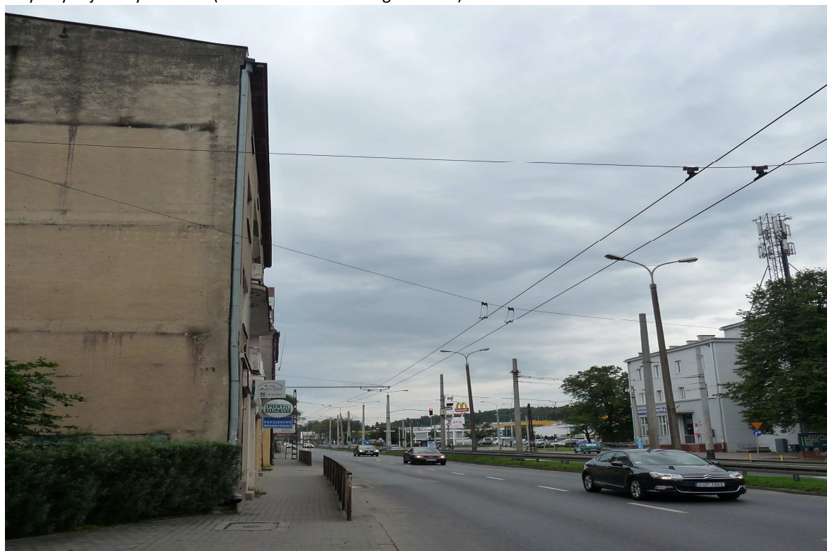
Ul. Wielkopolska stanowiąca fragment drogi wojewódzkiej nr 474 (ul. Chwaszczyńska, ul. Wielkopolska) łącząca Gdynię z drogą krajową nr 22 to dwupasmowa droga w obu kierunkach, oprócz istniejącej zabudowy blisko drogi; wielu wjazdów i zjazdów; posiada istniejącą trolejbusową sieć trakcyjną, co powoduje, że zastosowanie ekranów akustycznych jest wykluczone (foto: SecTec Adam Naguszewski).
