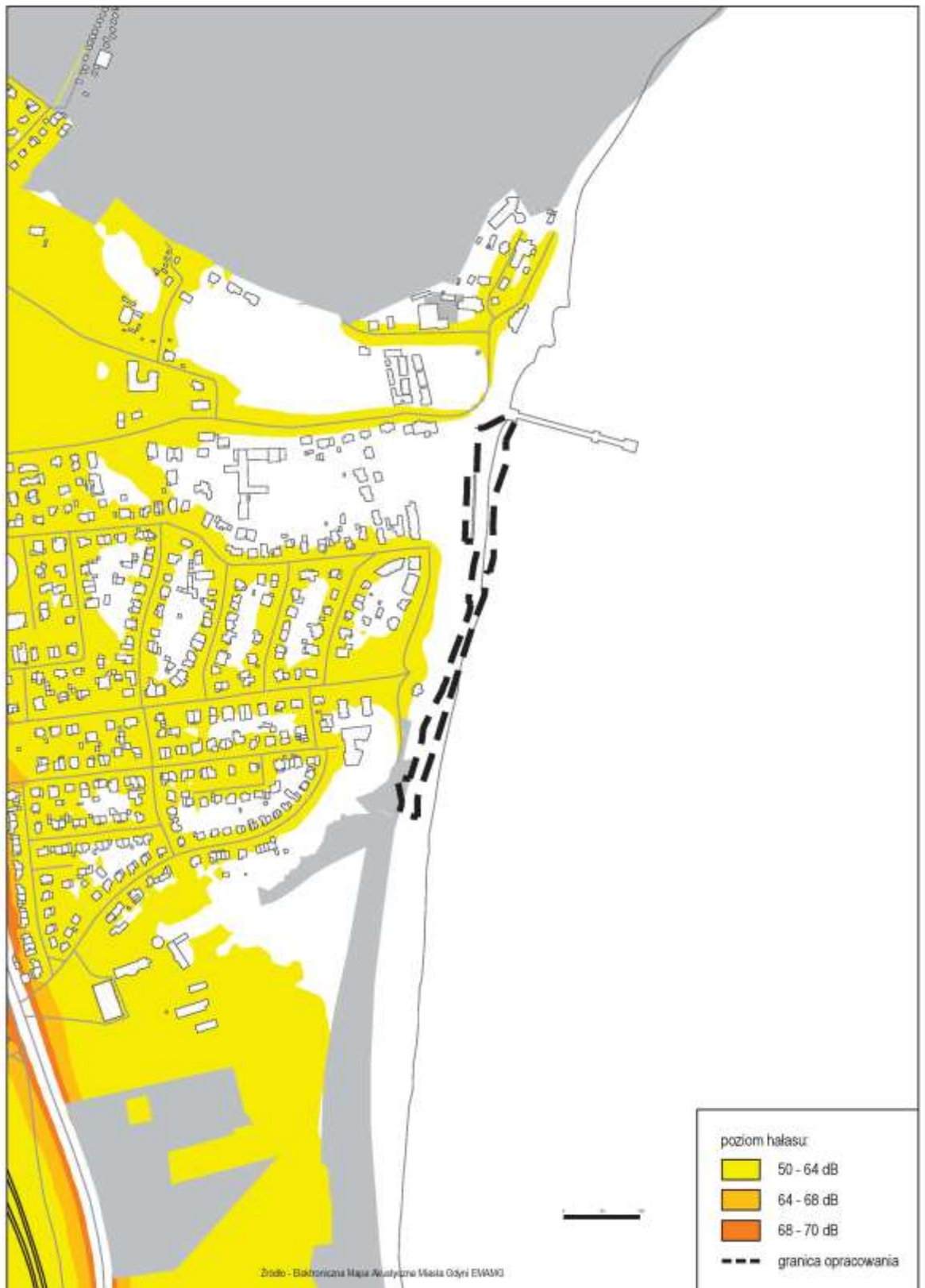
Ryc. 2. Hałas drogowy - długookresowy średni poziom dźwięku A (dB) dla pory dnia, wieczoru i nocy LDWN .
